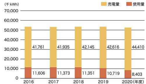
また、2013年4月には再生可能エネルギー固定価格買取制度の設備認定を取得し、2020年度は52,813千kWh発電、44,410千kWhの電力を販売しました。
